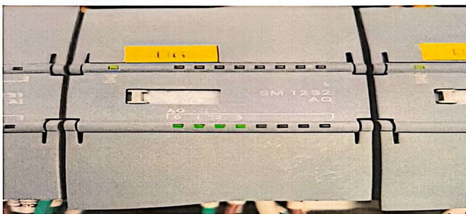
15、技术规范书序号15 PLC模块，型号：S7-1200 SM1232 AQ
